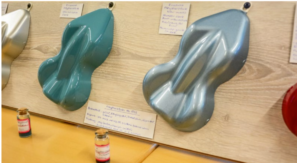
Alkydharzlacke gab es ab 1932. Links: Einschicht-Alkydharzlack blau mit hohem Glanz, rechts: Einschicht-Alkydharzlack, blau-metallic, stumpfer Glanz durch unkontrollierte Ausrichtung der feinen Aluminiumpigmente im Lack.
