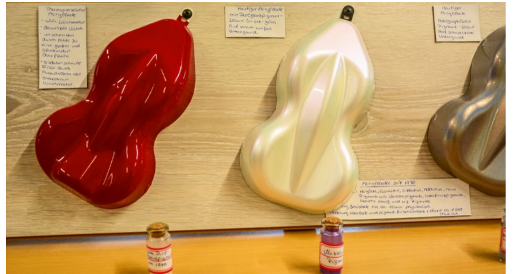
In den 1970er-Jahren kamen Acryllacke zum Einsatz. Links: Thermoplastische Acryllacke bildeten durch das Auswandern der Weichmacher schnell Risse; rechts: heutiger Acryllack mit Perlglanzpigment-Lasur in rot-grün auf einem weißen Untergrund.
